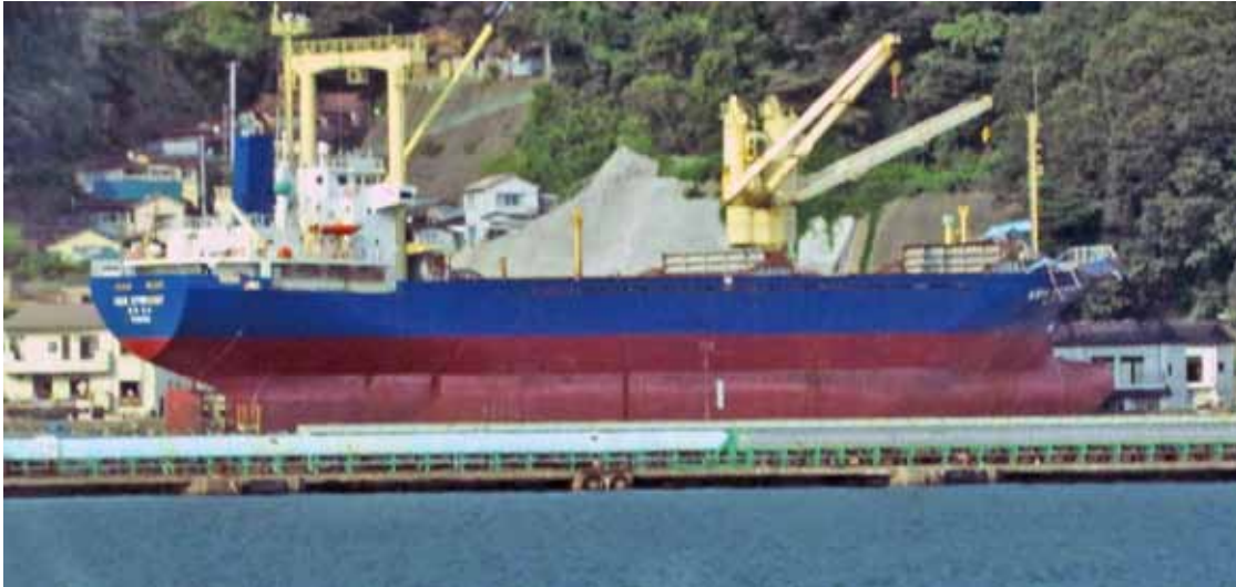
港のあらゆる建物を壊し、岸壁に乗り上げた6175トンの貨物船（釜石港）
